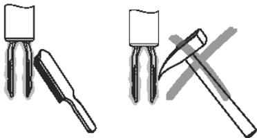
Рисунок 12 – очистка камертона
