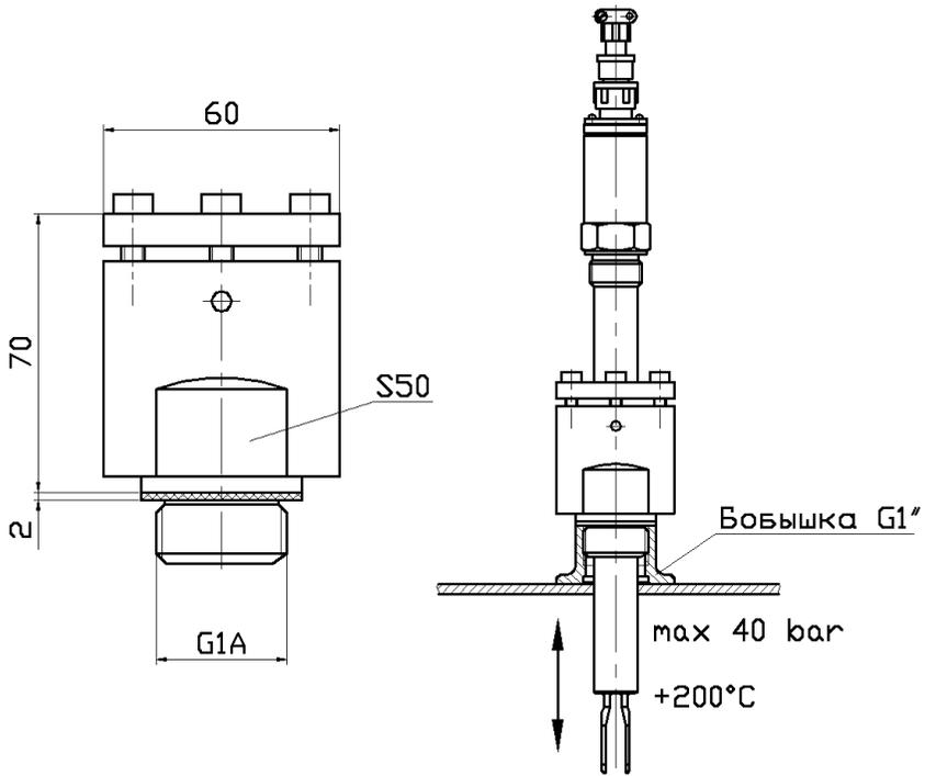
Рисунок А.3 – Втулка передвижная и установка СУ
