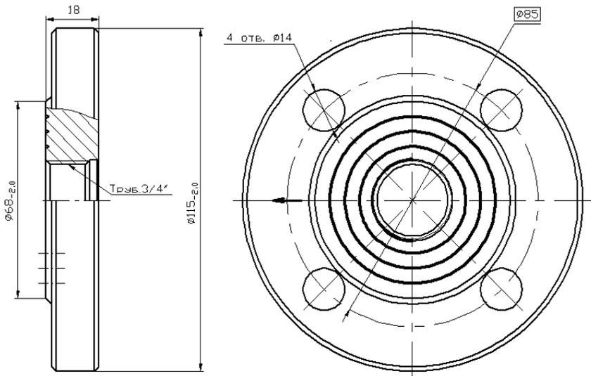
Рисунок А.4 – Фланец монтажный Ду25 / G 3/4"
